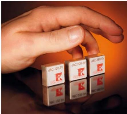
Toutes ces versions ont un design extrêmement robuste et compact, et un boîtier commun plaqué nickel de 21 mm x 10 mm. De plus le coefficient de température de la tension de sortie peut être ajusté précisément pour s'adapter à l'APD correspondante. Des photodiodes APD comme les modules APD peuvent être utilisés, même avec un senseur de température intégré.
