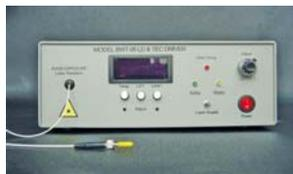
performances de BWT, elles ont été développées pour les besoins de la recherche et de l'enseignement. Ces lasers se caractérisent par un profil de distribution de puissance Gaussien dans les gammes de 250 mW à 2.8 W.
