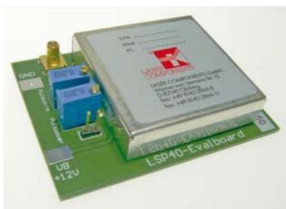
dule requiert une tension d'alimentation de +12VDC et un signal de trigger externe.
