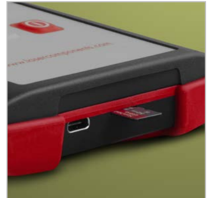
Bild 8: USB-Schnittstelle und microSD-Kartenslot
